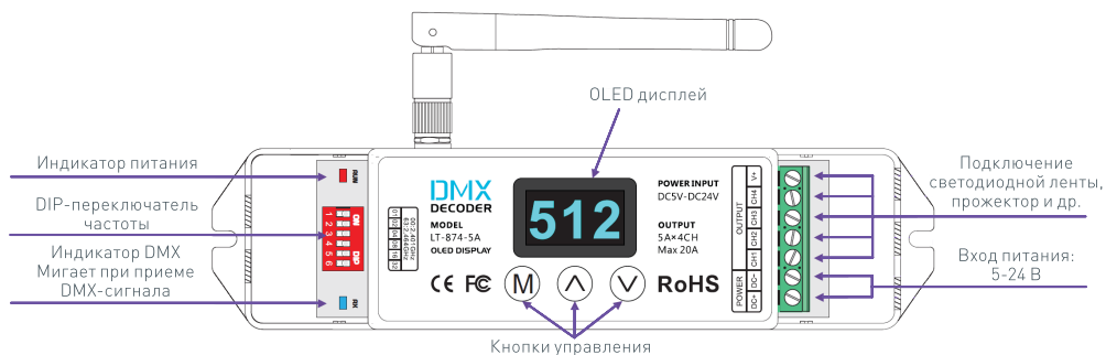
Рис. 1. Органы подключения и элементы управления.
