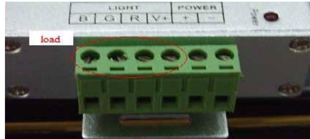
Клеммы для подключения RGB ленты. **Соблюдайте полярность при подключении!**
