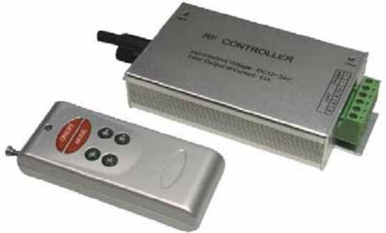
Управление контроллером осуществляется с помощью радиопульта 433 МГц. На контроллере есть регулировка чувствительности звука. Имеются отдельные входы для микрофона и сигнала с плеера (медиапроигрывателя).
