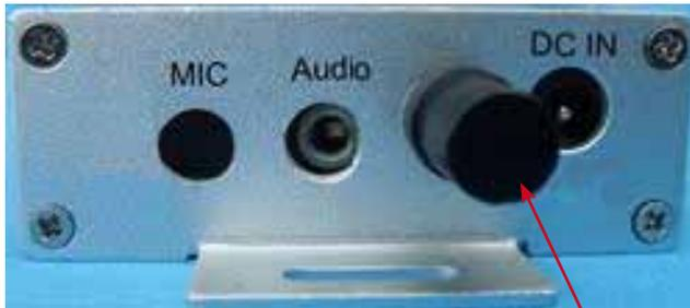
**MIC** - Вход для микрофона, **Audio** - Вход для плеера, Регулятор чувствительности
