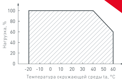
Рис. 6. Максимальная допустимая нагрузка, % от мощности источника.
