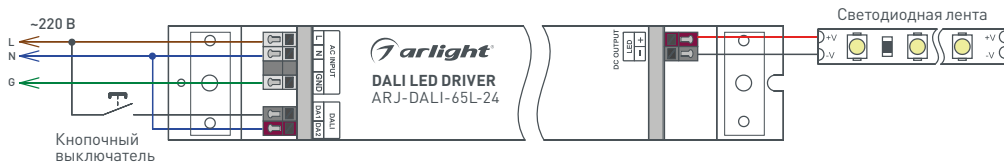
Рис. 1. Подключение источника напряжения при использовании интерфейса DALI.
