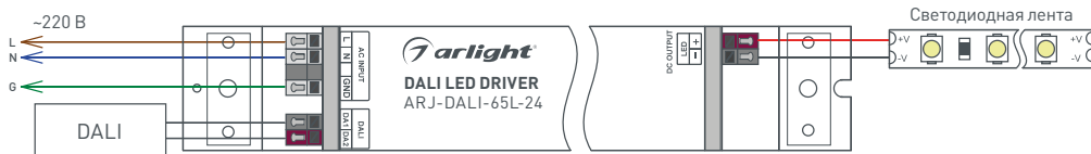
Рис. 1. Подключение источника напряжения при использовании интерфейса DALI.
