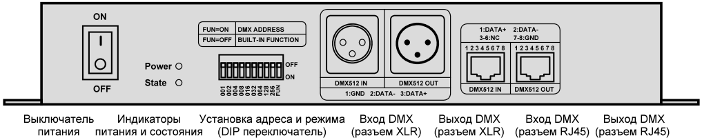
Рис.1. Расположение и назначение органов подключения и управления на передней панели.
