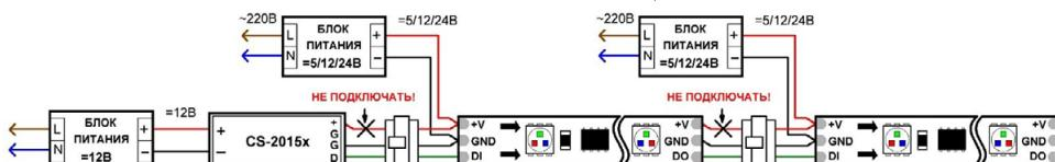
Рис.4. Подключение нескольких светодиодных лент.
