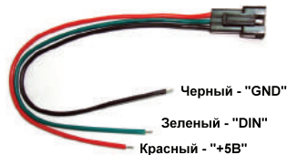
Рис.3. Кабель для подключения открытой ленты и ленты с индексом «SE»
