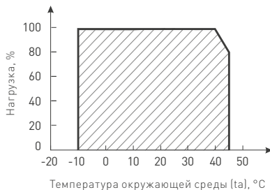
Рис. 2. Максимальная допустимая нагрузка, % от мощности источника
