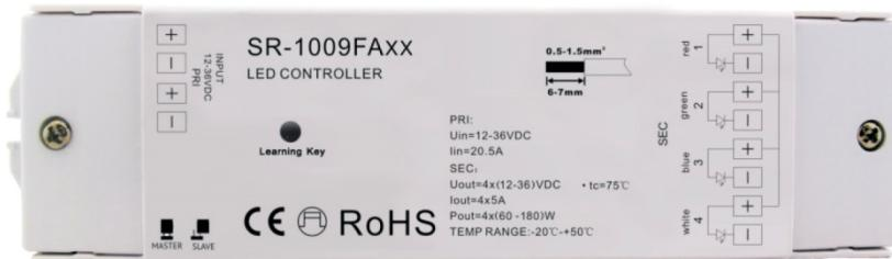
С сенсорной панелью могут работать ряд контроллеров различной мощности, с различными типами выхода и различного назначения. Все контроллеры имеют 4 выходных канала. Два из них используются для подключения источников «теплого» света, два – «холодного» (см. схему подключения).
