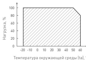
Рис. 3. Максимальная допустимая нагрузка, % от мощности источника
