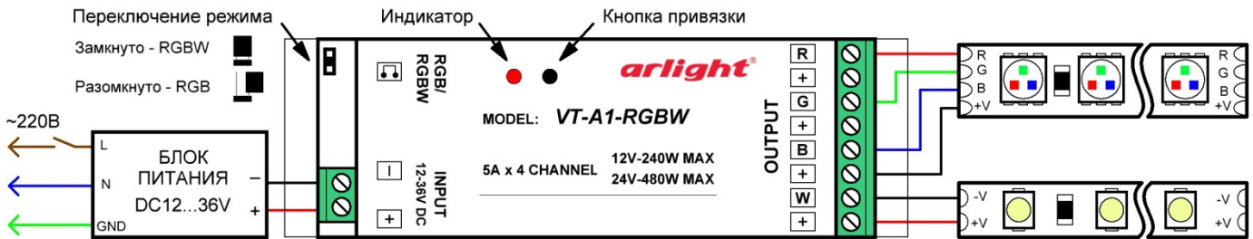
Схема 2. Подключение контроллера
