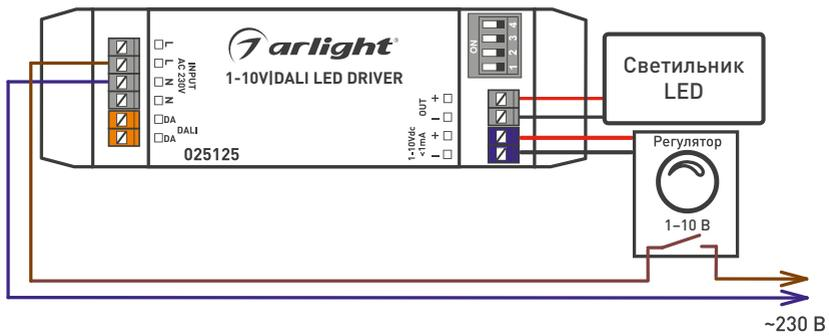
Рисунок 3. Подключение источника тока при управлении регулятором 1-10 В
