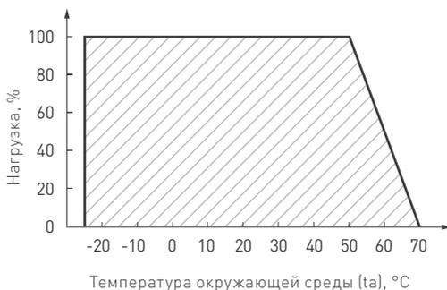
Рисунок 7. Максимальная допустимая нагрузка, % от мощности источника
