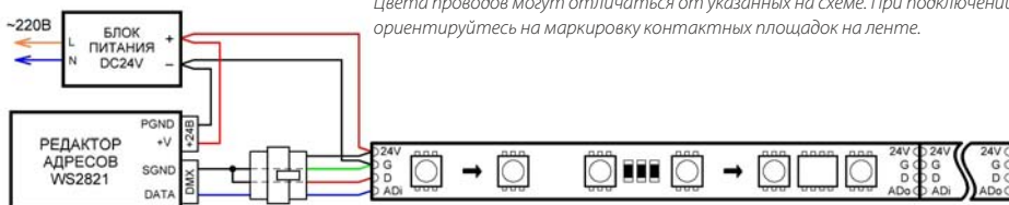
Схема подключения ленты при записи DMX адресов
