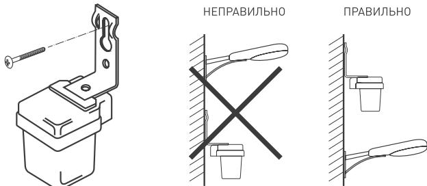
Рис. 1. Монтаж и размещение фотореле.
