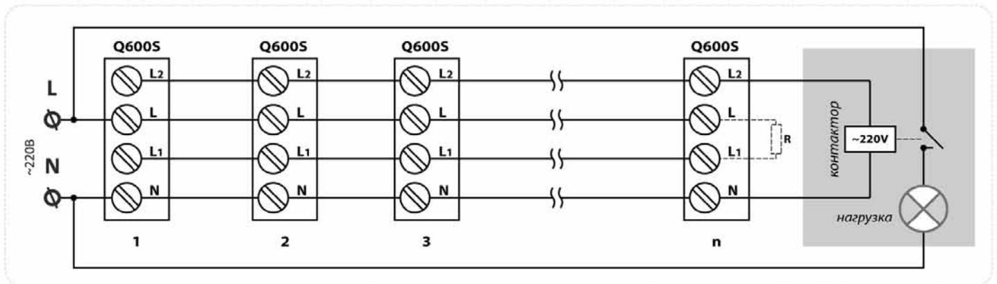
Схема с внешним контактором обеспечивает управление нагрузкой, мощность которой может существенно превышать номинальную паспортную мощность Q600-S. Тип и мощность нагрузки в этом случае определяется паспортными характеристиками используемого контактора. Для наглядности показано линейное расположение Q600-S, на практике расположение значения не имеет.
