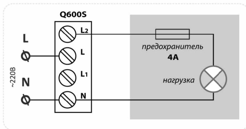
В качестве нагрузки могут использоваться энергосберегающие LED или КЛЛ лампы, а также электронные трансформаторы для галогеновых ламп или LED светильников. Все эти устройства имеют встроенные предохранители.
