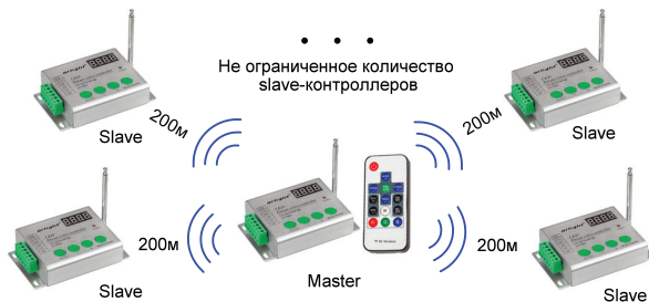
Рис.3. Синхронная работа нескольких контроллеров, дальность до 200 м на открытом пространстве.
