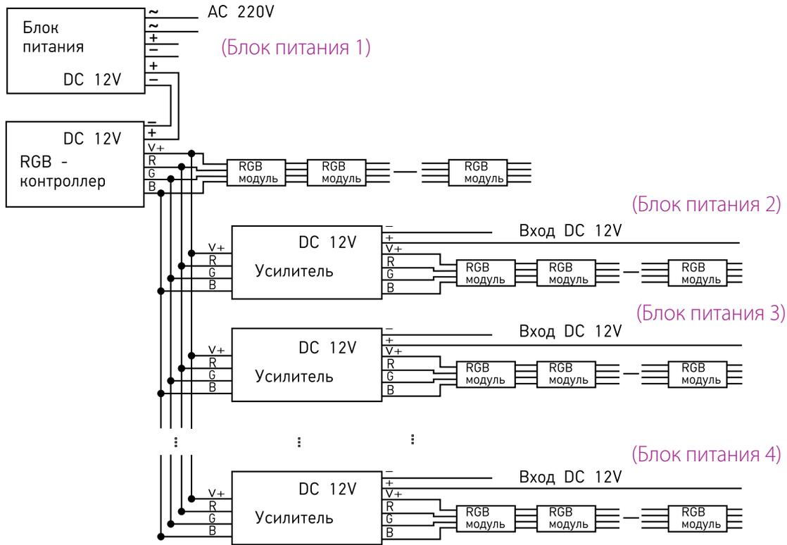
Схема 3. Параллельное подключение. Блок питания 1 шт
