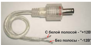
Рис.2. Коннектор питания. Подключается к блоку питания DC 12В.
