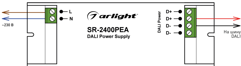
Рис. 2. Подключение блока питания ARV-SR-2400PEA.
