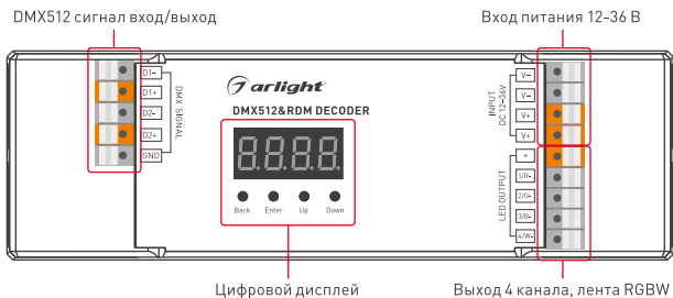
Рисунок 1. Внешний вид и назначение разъемов декодера.
