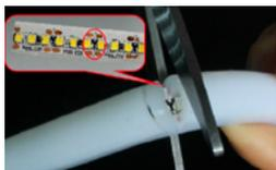
Перемещая ножницы левее или правее, найдите специальное место разреза на плате. Разрежьте ленту строго по обозначенной линии.
