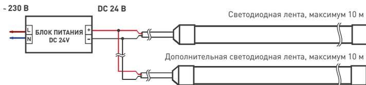
Рисунок 2. Схема подключения лент к источнику питания
