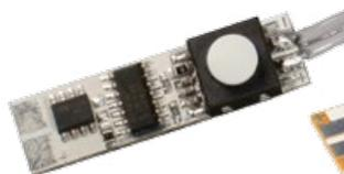
Микровыключатель 12V для PDS с проводом 1.5м
