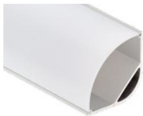
Анодированный алюминиевый профиль для светодиодной подсветки прямых углов. Широко используется для мебельной, витринной и интерьерной подсветки. Сглаженный угол профиля KANT-H30 позволяет устанавливать его в неровные углы. К профилю подходят круглый или квадратный экраны, разной степени прозрачности. Материал экрана PMMA.
