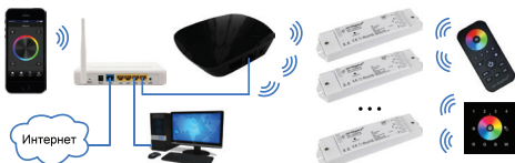
Рис.3. Подключение через роутер с использованием проводного соединения.
