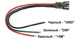
Рис.3. Кабель для подключения открытой ленты и ленты с индексом «S»
