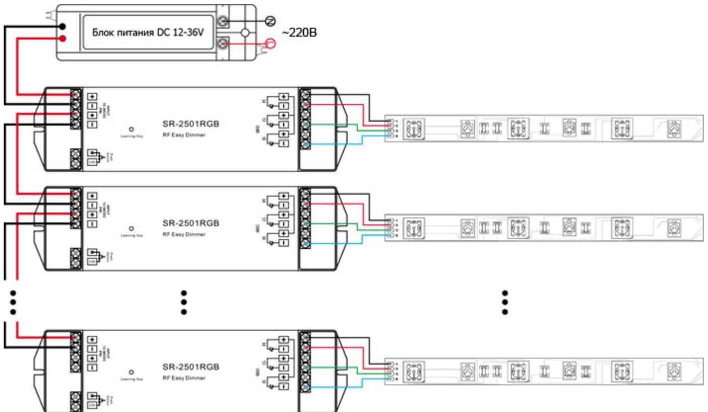
При использовании нескольких контроллеров удобнее использовать отдельный блок питания для каждого контроллера. В этом случае используется первая схема подключения.
