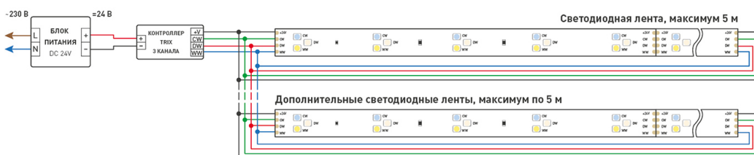
Схема 2. Подключение нескольких светодиодных лент с двух сторон. Рекомендуется использовать для обеспечения равномерного свечения ленты по всей длине.
