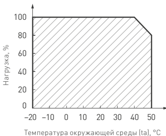
Рис. 2. Максимальная допустимая нагрузка, % от мощности источника
