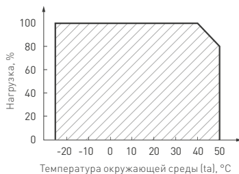
Рис. 2. Максимальная допустимая нагрузка, % от мощности источника
