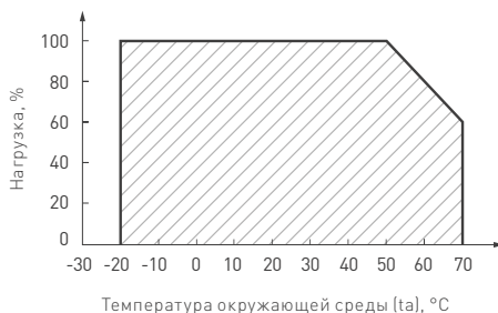
Рисунок 2. Максимальная допустимая нагрузка, % от мощности источника.
