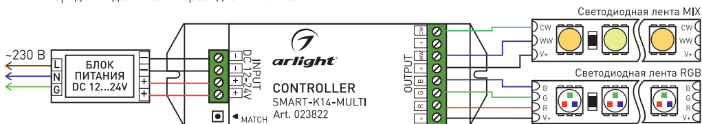
Рисунок 1. Схема подключения контроллера
